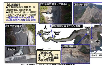
UAVの自律飛行による天然ダムおよび 砂防関係施設の点検・調査 【中電技術コンサルタント株式会社】
