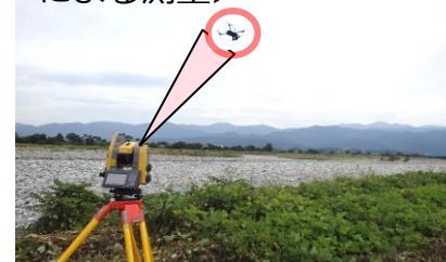
＜TSミラー搭載ドローン による測量＞
