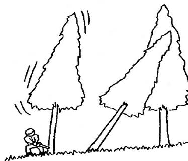
図4 カカリ木に激突させるためにかかり木以外の立木を伐倒
