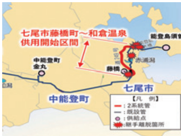
図-3 被災箇所及び断水状況
