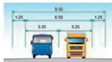
図-2 標準断面図
